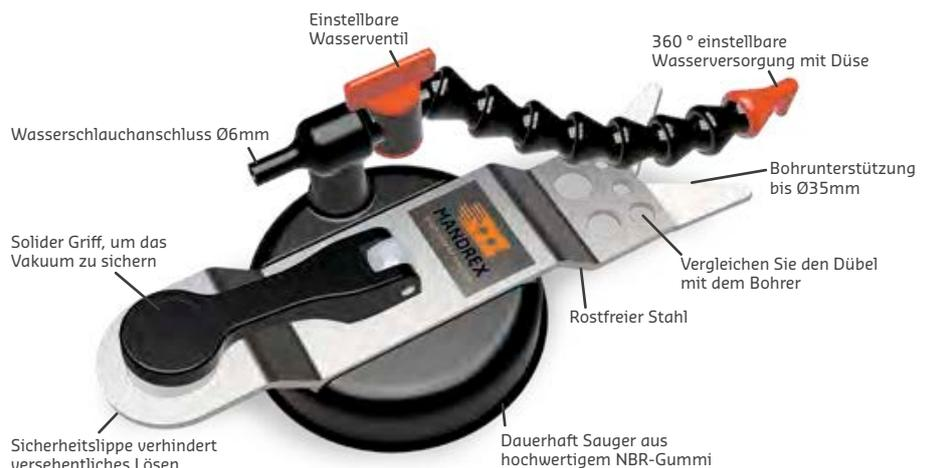
Einfach vakuummontiertes Zentrierhilfe, mit dem Sie sicher und stabil in alle Arten von Materialien bohren können. Drücken Sie es einfach gegen die Oberfläche und drücken Sie den Griff nach unten, um ihn zu sichern.
