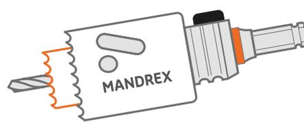
Ganz einfach! Jetzt können das kleinere Loch verwenden, um die Lochsäge zu zentrieren. Es ist einfach, ein Loch mit dem gewünschten Durchmesser zu bohren. Ein zusätzlicher Adapter ist erforderlich.
